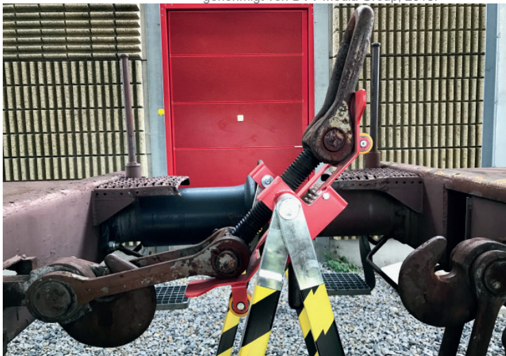
BILD 4: Automatisches Entkuppeln einer Schraub- enkupplung
