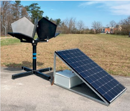
Test der Corner-Reflektoren am AIT-Standort Seibersdorf: Sie werden später auf der Brücke Schottwien angebracht.
